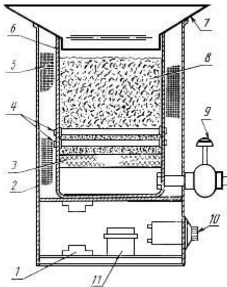
1 - блоки электропроводки и соединителей; 2 - внешний корпус; 3 - пористая пластина;
