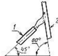
Образец расположен вертикально, пламя контактирует с концом образца
