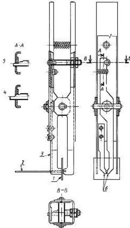
1 - испытываемый образец (25x30); 2 - проволока; 3 - отметка уровня погружения на зажиме;
