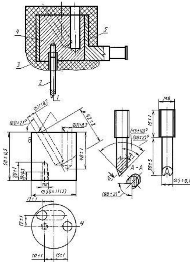
1 - отверстия для термометров; 2 - жало паяльника; 3 - изоляция; 4 - латунный блок;
