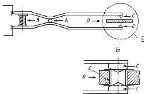
*A* - изолирующая втулка; *B* - нажимная пружина; *C* - положение испытательных щупов (из нержавеющей стали) на отверстиях испытательной платы; *D* - печатная плата; *E* - металлическое покрытие
