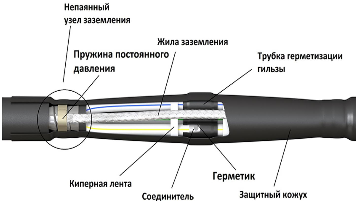
Термоусаживаемые материалы в комплектации соединительной муфты после усадки сохраняют механические свойства и электрическую прочность не менее  $30 \text{ кВ/мм}^2$  при температуре от  $-55$  до  $+125$  °С.
